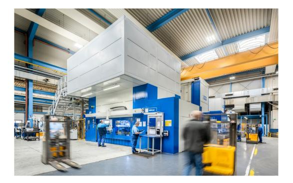
Meilenstein für Grammer auf dem Weg zur Sitzfertigung 4.0: Die neue 800 Tonnen-Servotransferpresse am Standort Haselmühl ist die größte Einzelinvestition im Rahmen des "Mayflower"-Projekts zum Ausbau von Kapazität und Produktivität. Quelle: GRAMMER AG
