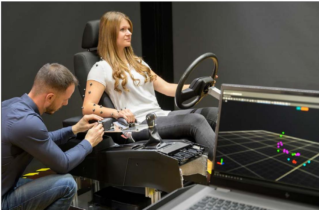
*Anwender im Mittelpunkt: Im Test-Cube des Grammer ErgoLabs werden Ergonomie, Haptik und intuitiver Bedienkomfort von Mittelkonsolen bei unterschiedlichen Lichtverhältnissen geprüft.*
