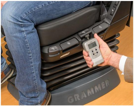
Genaueste Prüfung: Mit professionellem Equipment wird zum Beispiel die aufzuwendende Bedienkraft für Schalter gemessen.
