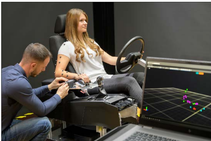
Anwender im Mittelpunkt: Im Test-Cube des Grammer ErgoLabs zeichnet ein Kamerasystem Nutzerprofile – hier im Automotive-Interieur – zu unterschiedlichen Sitzmodellen und Anwendungsfällen auf.
