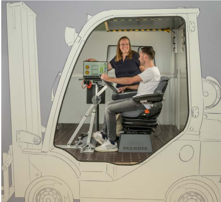
Komfort- und Ergonomietests im Grammer ErgoLab: Dr. Susanne Frohriep, R&D Senior Manager Global Ergonomics, Usability & Design beim Probandengespräch im Kabinen-Mockup eines Staplers.
