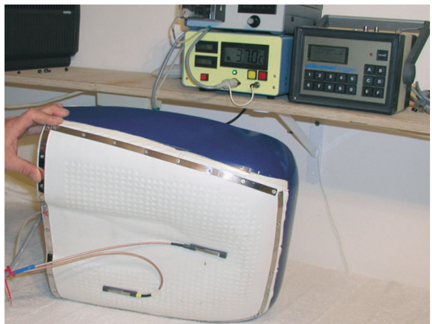
Bild 2: Klimadummy mit Temperatur- und Feuchtesensoren
